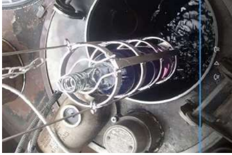
รูปแสดงการเก็บตัวอย่างน้ำมันในถังรถ
